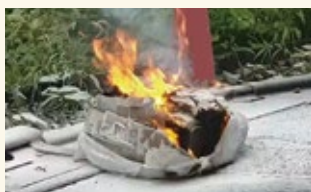
リチウムイオン電池の誤廃棄により出火したごみ袋
